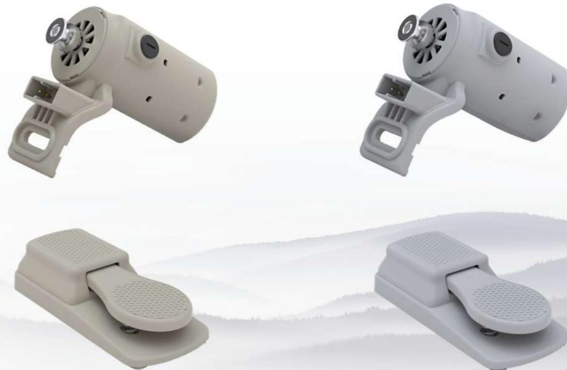
电机采用永磁结构设计, 电子无级调速控制, 能效比高达72%, 扭矩为串激电机的3倍, 可适用于功率为80-300W的机型。
