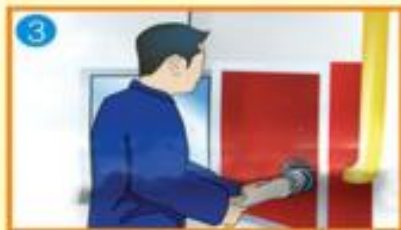
3 水带一头接到消防栓接口上
