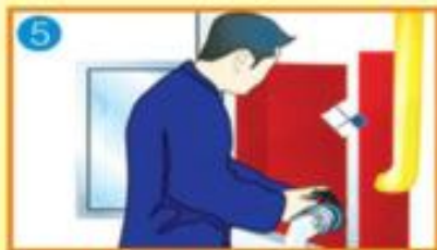
5 另外一人打开消防栓上的水阀开关
